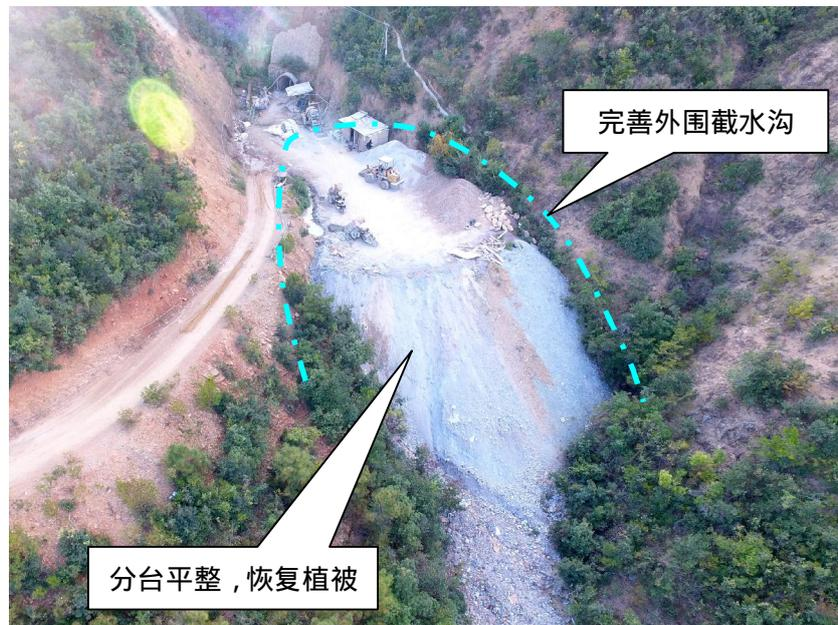
图 20：老尖山隧洞出口处弃渣场完善示意
