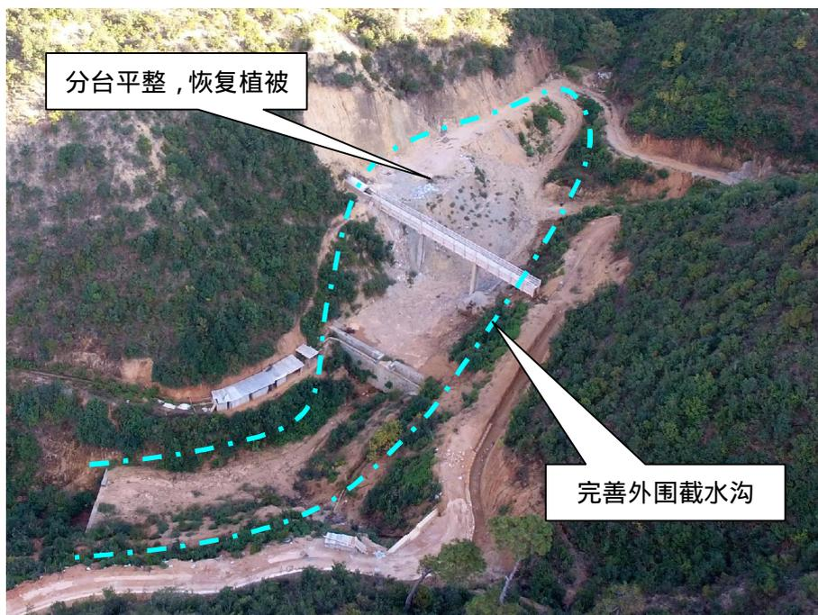
图 21：绞苴隧洞入口处弃渣场完善示意
